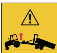
Figur 23. Varning – Lyfter traktorn i bakkant har farlig rörelse påbörjats
