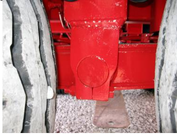
Axe du bogie a dévié Figur 39.
