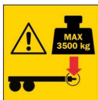
Figure 26. Pression maximale sur l'œillet d'attelage
