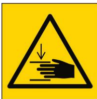
Figure 19. Risque de blessure par serrage
