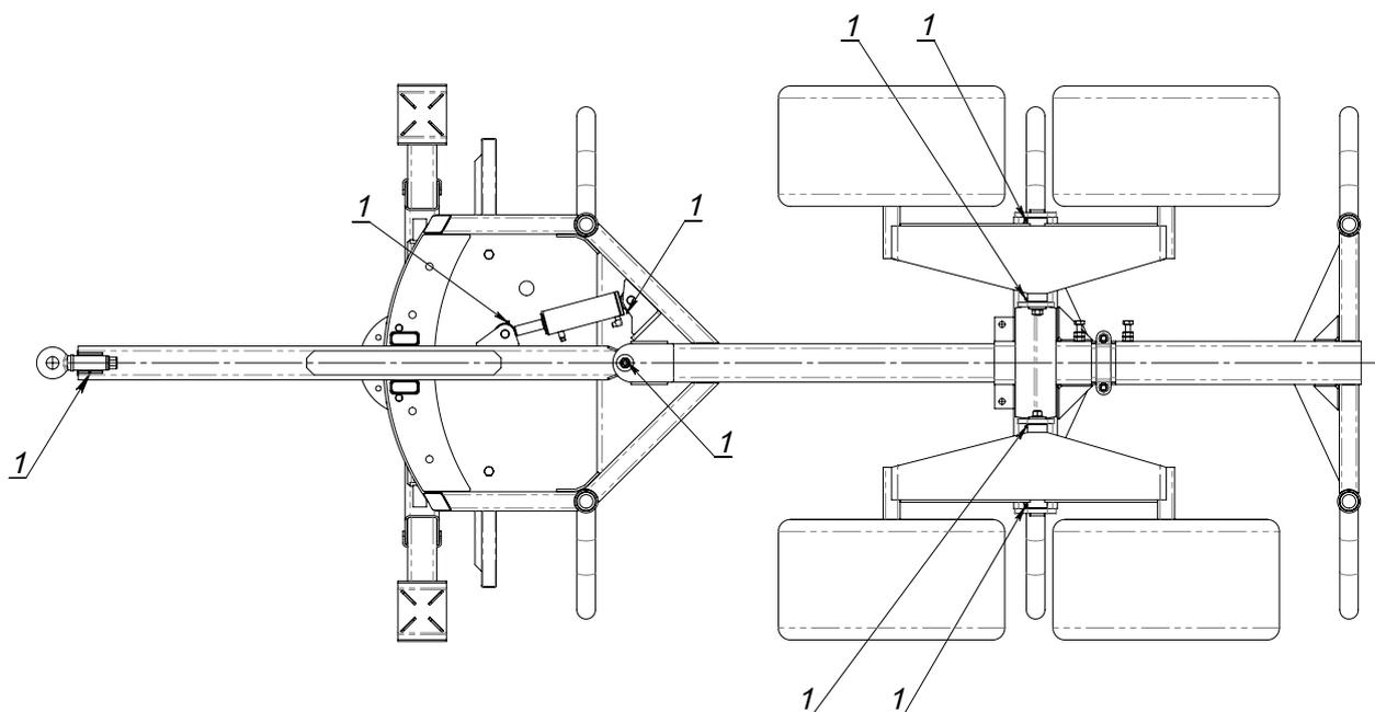
*Calendario de lubricación de todos los remolques hasta el modelo de 12 toneladas.*
