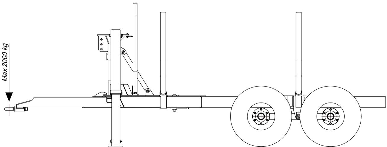
La carga vertical sobre la argolla de remolque no puede superar el valor aprobado para el dispositivo de remolque del vehículo remolcador, o un máximo de 2.000 kg. Dicha carga está determinada principalmente por cuatro factores:
